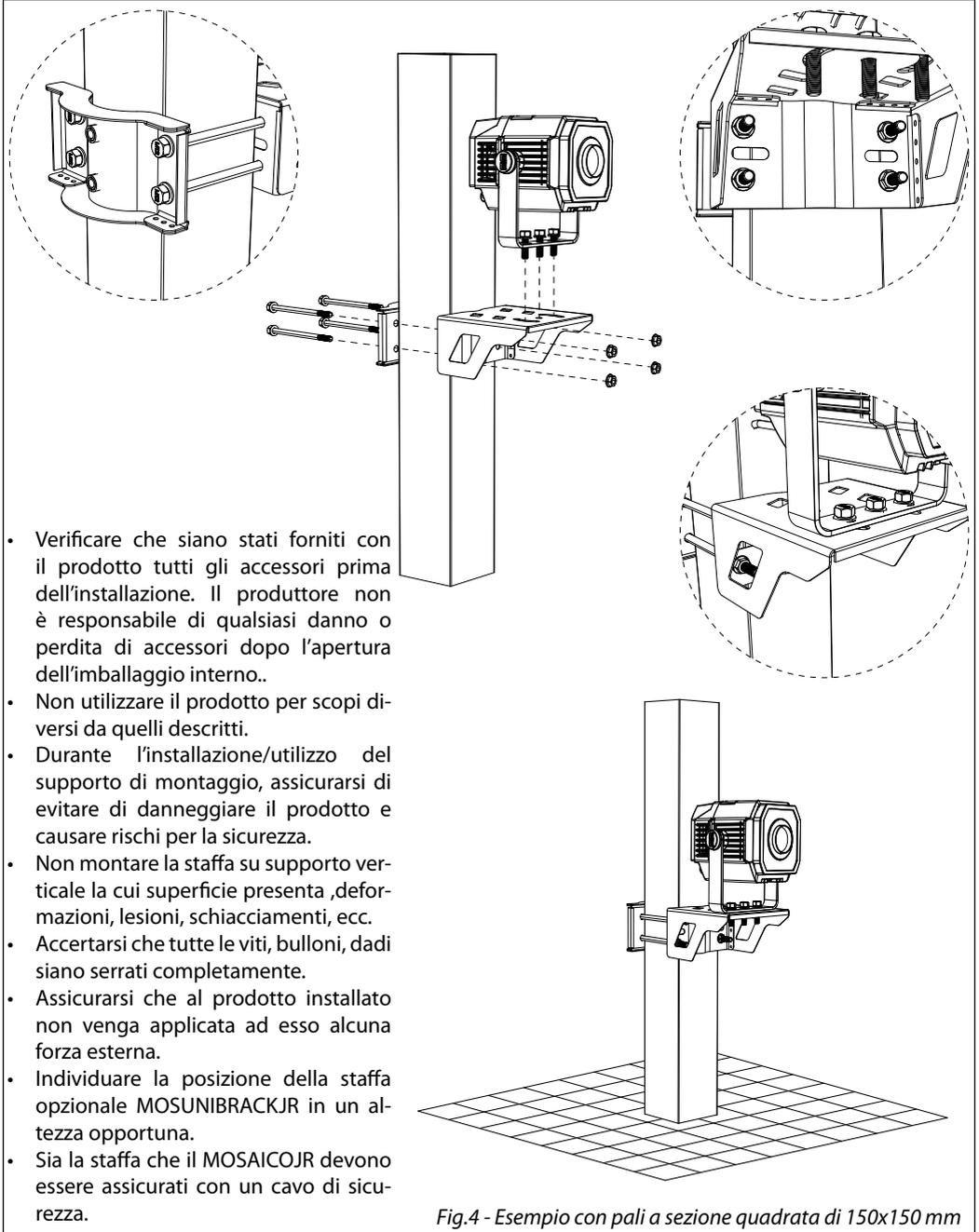
Fig.4 - Esempio con pali a sezione quadrata di 150x150 mm
