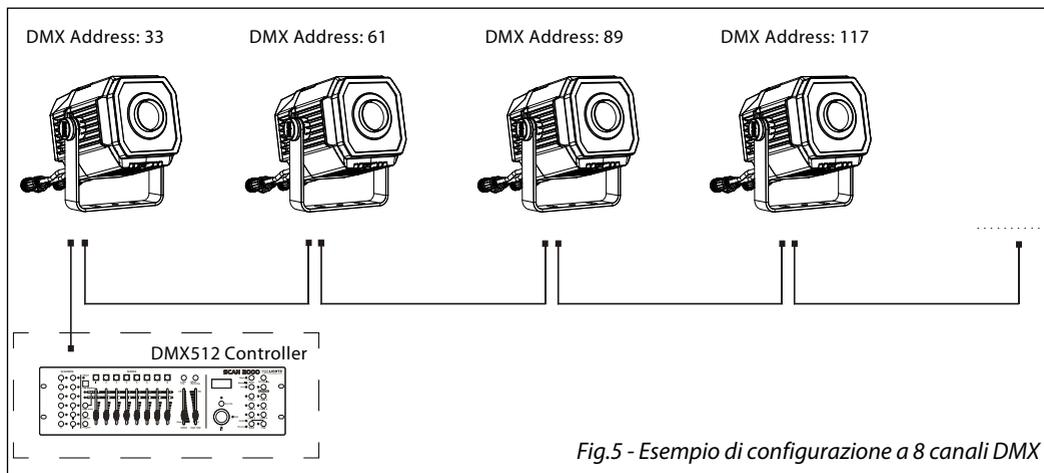
Fig.5 - Esempio di configurazione a 8 canali DMX
